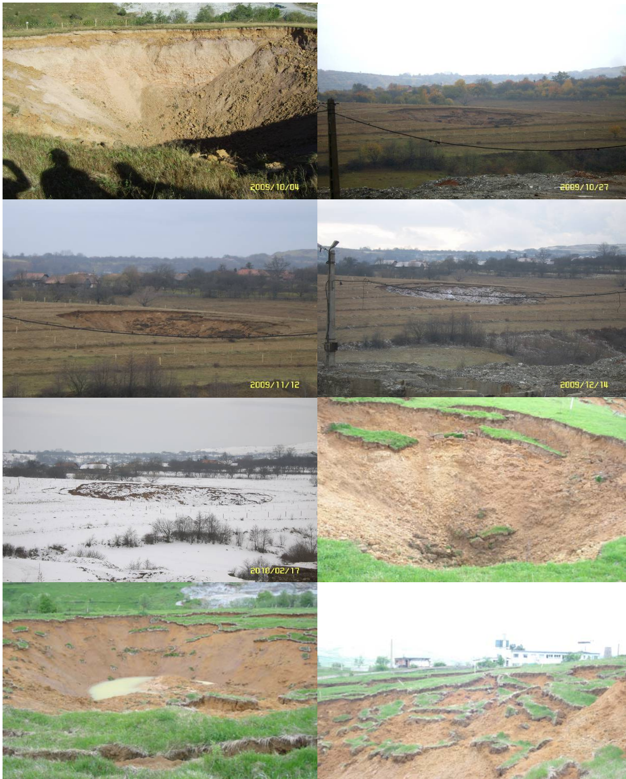
Figure 5. Evolution subsidence cone mask throughout the monitoring period a.04.10.2009, b. 27.10.2009, c. 12.11.2009, d. 14.12.2009, e. 17.02.2010 alarm situation, f. 15.03.2010, g. 08.05.2010, h. 28.08.2010
